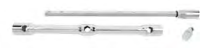
Chave de rodas com 3 peças Pode ser utilizado em + ou em “T” Medidas: 17; 19 e 21mm Tubo perfurado 355mm com chave de 19 e 21mm Tubo perfurado 395mm com chave de 17mm Adaptador 1/2”
