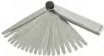
Apalpa folgas com 20 lâminas Medidas (mm): 0,05; 0,10; 0,15; 0,20; 0,25; 0,30; 0,35; 0,40; 0,45; 0,50; 0,55; 0,60; 0,65; 0,70; 0,75; 0,80; 0,85; 0,90; 0,95 e 1
