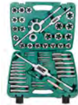
Jogo de machos e caçonetos com 53 peças Composição: 15 Machos 38mm: M6x0,75; M6x1,0; M8x1,0; M8x1,25; M10x1,25; M10x1,5; M12x1,25; M12x1,5; M12x1,75; M14x1,5; M14x2,0; M16x1,5; M16x2,0; M18x1,5 e M18x2,5 6 Machos 50mm: M20x1,5; M20x1,5; M22x1,6; M22x2,5; M24x1,5 e M24x3,0 21 Caçonetos: M6x0,75; M6x1,0; M8x1,0; M8x1,25; M10x1,25; M10x1,5; M12x1,25; M12x1,5; M12x1,75; M14x1,5; M14x2,0; M16x1,5; M16x2,0; M18x1,5; M18x2,5; M20x1,5; M20x2,5; M22x1,5; M22x2,5; M24x1,5 e M24x3,0 5 Extratores 1 Porta caçonetos 1 Desandador de machos (M6 - M25) 1 Desandador de machos (M4 - M12) 1 Chave phillips PH2 38mm 2 Adaptadores de Ø 50mm
