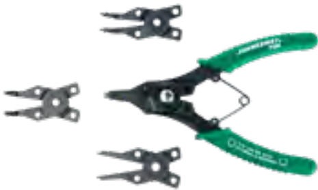
Alicate de freios internos e externos (pontas intermutáveis) Capacidade: freios de 12 a 50mm Pontas de: Ø1,2 e 1,5mm Pontas direitas de: 45 e de 90°
