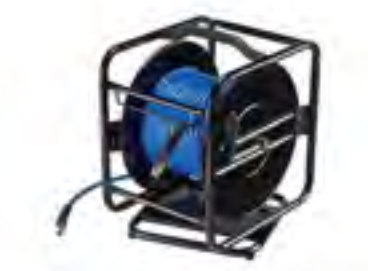
Enrolador móvel para ar de 3/8" Comprimento: 20m Pressão máxima: 15bar Peso: 7 000g Interior mangueira: 9,5mmø Ligação: 3/8"
