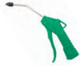
Pistola para ar de bico longo de 1/4" Comprimento: 100mm Pressão trabalho: 75-120psi Ruído: 85-90dba Fêmea: 1/4"
