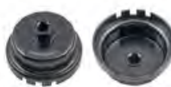
Chave de copo para filtros de 14 faces 3/8" com 64,5mm Marca Modelo Motorização TOYOTA Auris/ Corolla/ Prius 1.8/ 2.0 4 cilindros
