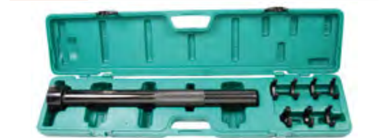
Removedor da barra de direção Estas ferramentas são especialmente projetadas para os tirantes internos que são inacessíveis para o ajuste. A chave longa pode ser facilmente usada com sete chaves de bocas, tamanho: 1-3/16"; 1-1/4"; 1-5/16"; 1-7/16" e 14mm; 17mm; 33,6mm O tirante interno pode ser facilmente removido e instalado deslizando a chave longa sobre a extremidade do tirante e conectando-o à chave bocas
