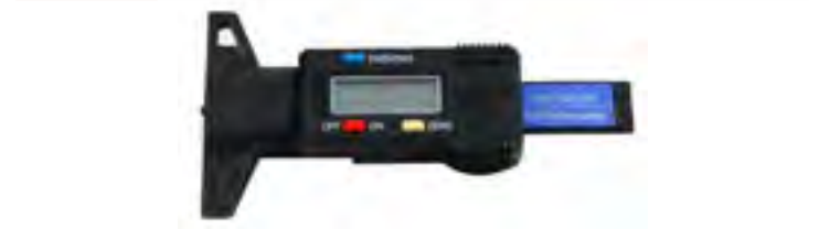
Medidor digital de profundidade Utilizado para medir a profundidade do piso dos pneus e das pastilhas de travões. Especificações: Gama de medição: 0-25,4mm Resolução: 0,01mm Display: LCD Medição em milímetros ou polegadas. Utiliza pilhas SR44/ LR44 de 1,4V (não incluídas).
