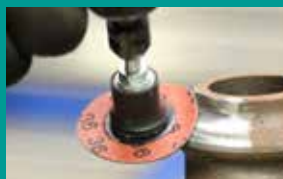
DICA: Para evitar golpes em contornos use um suporte mais pequeno do que o diâmetro do disco. Ex. suporte de 38mm para discos de 50mm.
