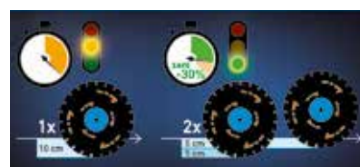
Indicador patenteado de profundidade de corte
